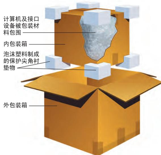
您可自行选择能保护货物在运送期间免受碰撞的特设泡沫塑料衬垫物。此包装方法让您只需使用同一大小的内包装箱、外包装箱和同一种的泡沫塑料衬垫物，就可以运送不同尺寸和重量的货物。
