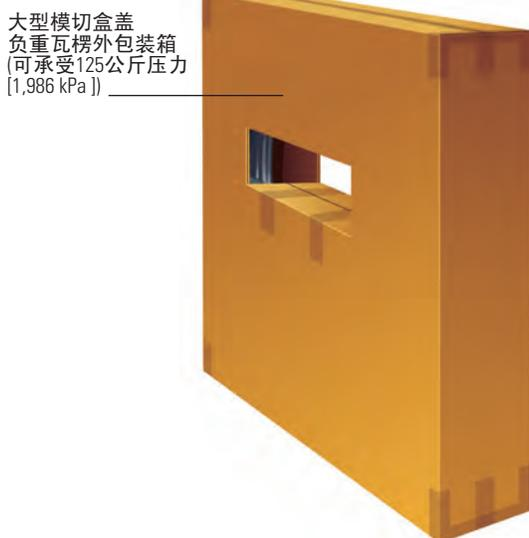
此设计同时使用了折叠垫、一个模切瓦楞间隔和一个模制间隔，以提供加垫和包裹车门的作用，再以外包装箱保护车门。
